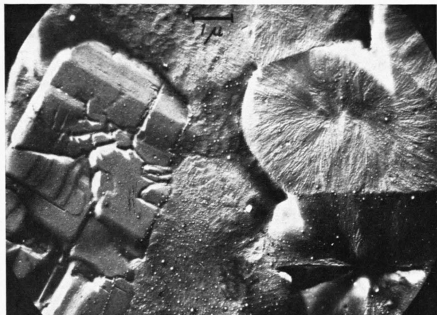
Abb. 1. Vergr.: 10000:1 Sphärolith- und Stäbchenstrukturen des Selen.
