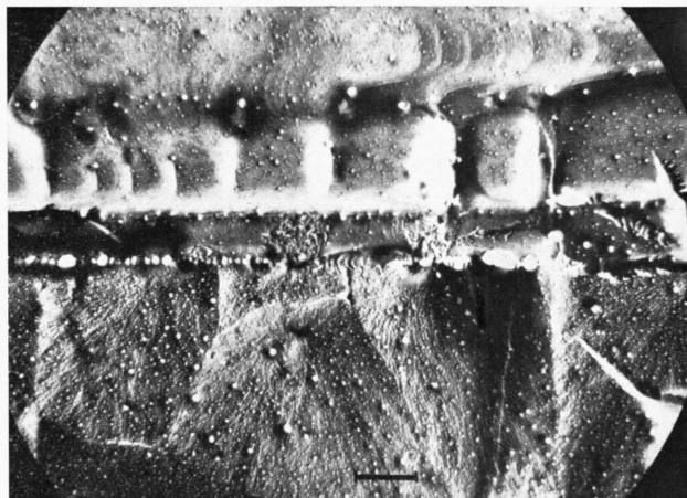
Abb. 2. Vergr.: 10000:1 Selen. Nadelwachstum.
